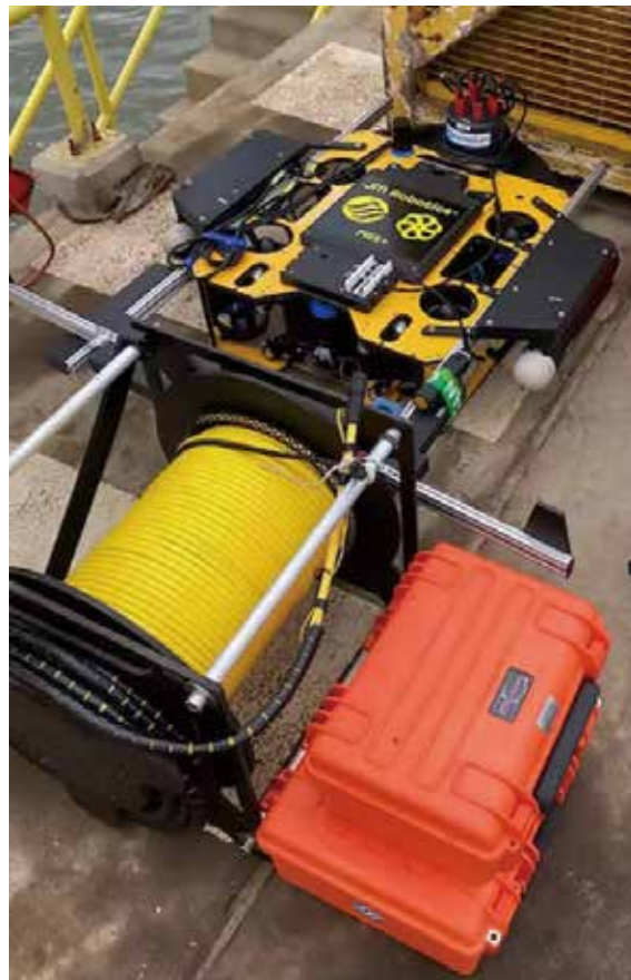
< 듀얼 FiGS 센서가 장착된 미니 ROV >
